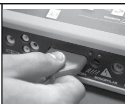
Figura 2. Enchufe el cable de alimentación de 3 clavijas al generador electroquirúrgico que prefiera, (Figura 2). Confirme que todos los ajustes de potencia del generador sean correctos para la intervención que se está realizando.
