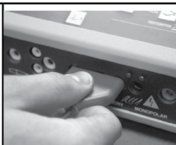
Figure 2. Brancher le cordon d'alimentation avec prise à 3 broches dans le générateur électrochirurgical de votre choix (Figure 2). Confirmer que les réglages électriques du générateur sont compatibles avec la procédure à réaliser. L'intensité du générateur électrochirurgical doit être la plus basse possible pour obtenir l'effet désiré. Le PlumePen® Ultra est une électrode monopolaire, l'utilisation d'une électrode dispersive est nécessaire pour éviter toute brûlure/ blessure au patient. Se reporter au manuel d'utilisation du générateur électrochirurgical et aux instructions d'utilisation de l'électrode dispersive pour des instructions additionnelles.
