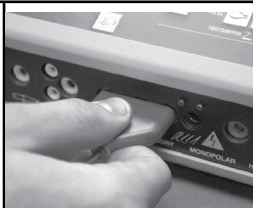
Figura 2. Ligue o cabo de alimentação de 3 pinos ao gerador electrocirúrgico pretendido (Figura 2). Confirme se todas as definições de potência do gerador são apropriadas para o procedimento a realizar. A intensidade do gerador electrocirúrgico deve ser definida no nível mais baixo necessário para atingir o efeito pretendido. O PlumePen® Ultra é um eléctrodo unipolar, sendo necessária a utilização de um eléctrodo dispersivo para evitar queimaduras/lesões no paciente.
