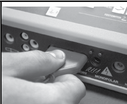
图 2. 将 3 向电源线插入您选择的电外科发生器 (图 2)。确认电外科发生器上的所有电源设置都适合当前正在执行的程序。
